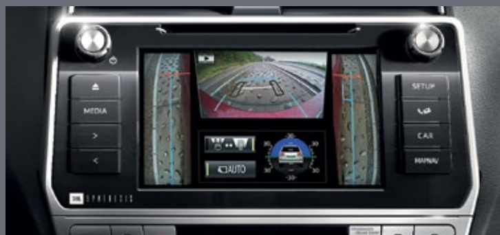
8-дюймовый сенсорный дисплей с выводом изображения с 4 камер панорамного обзора и изображения «Вид сквозь капот»
